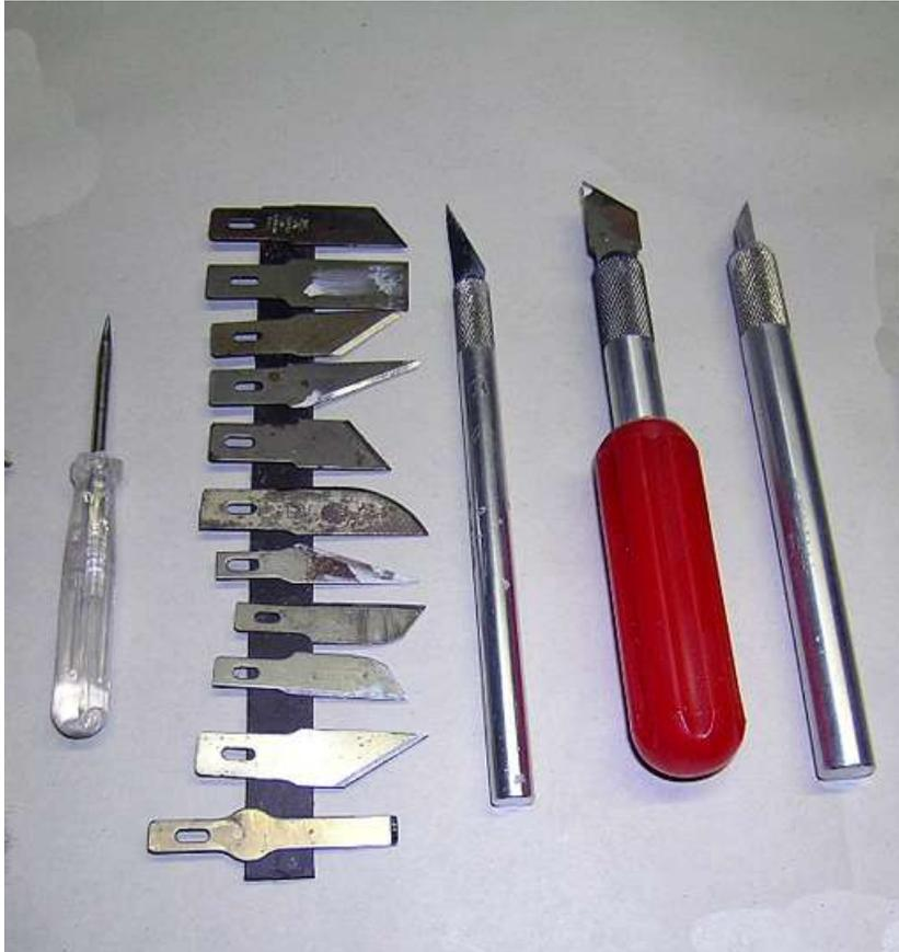
... de gauche à droite : l'aiguille montée et une série de lames de formes différentes pouvant être "clipsées" sur les 3 manches de scalpels de droite...
